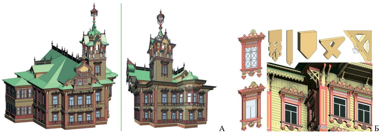
Рис. 2. Библиотечные элементы (Б) псевдорусского стиля, созданные для моделирования терема в селе Асташово Костромской области и общий вид модели терема (А) [1, с. 142]
